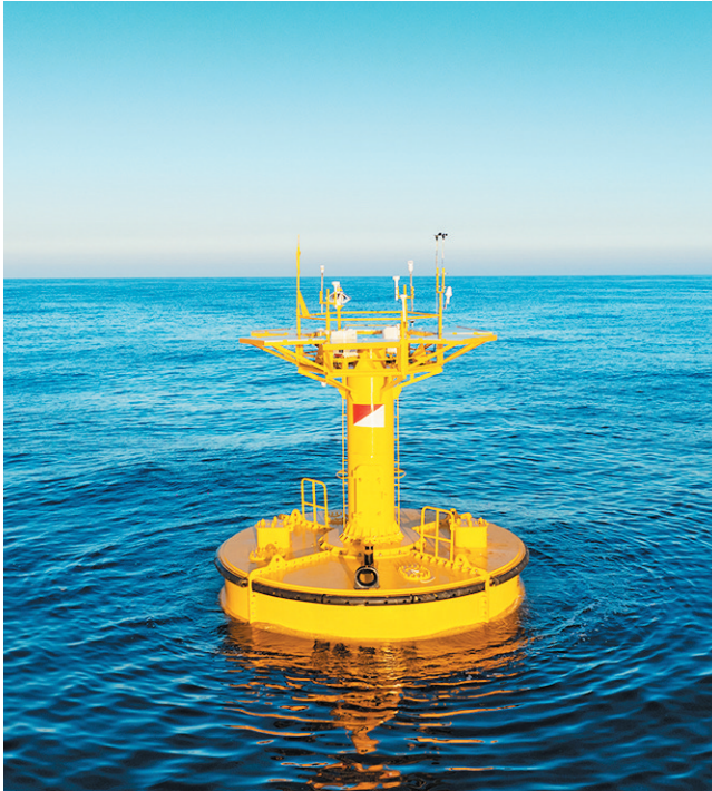
镭测创芯漂浮式测风激光雷达系统在海上进行风资源勘测。
