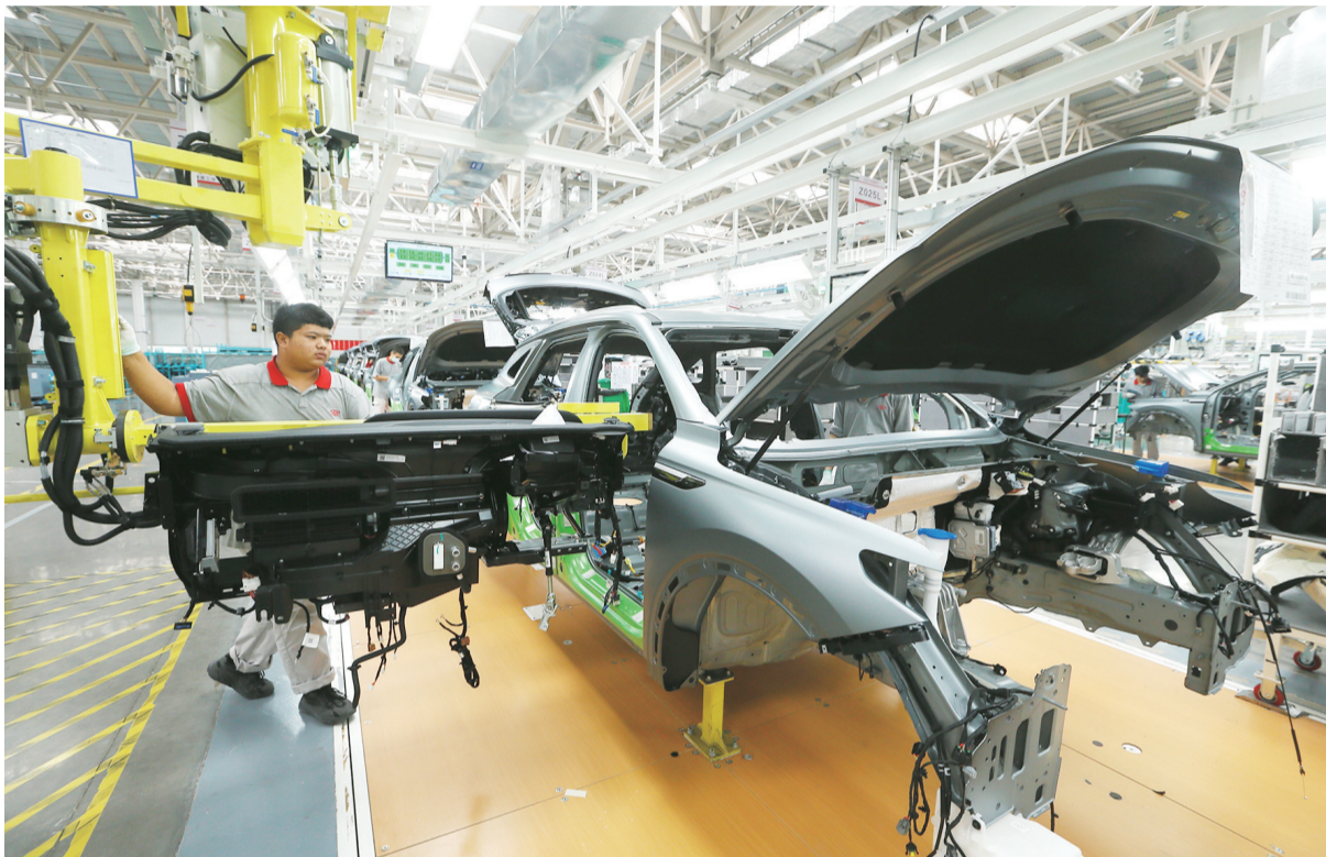
奇瑞汽车青岛基地的工人在总装车间安装汽车内饰。经济发展新高地。
