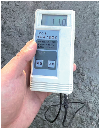
测温仪测混凝土温度。
