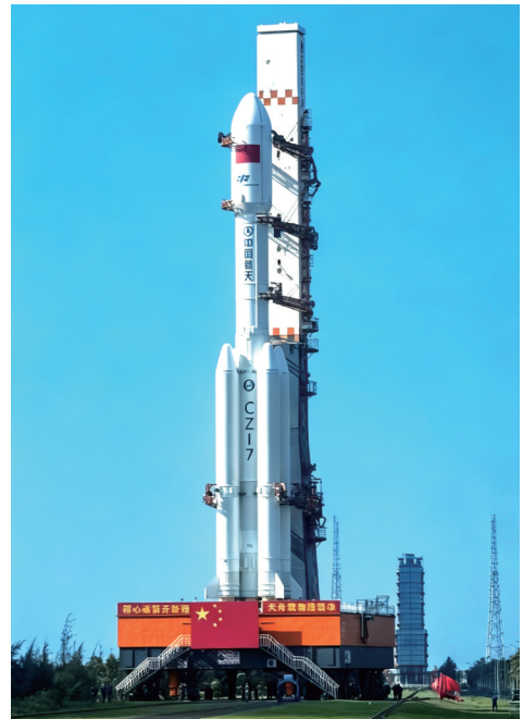
■5月8日,天舟十号货运飞船与长征七号遥十一运载火箭组合体在垂直转运中。 新华社照片
