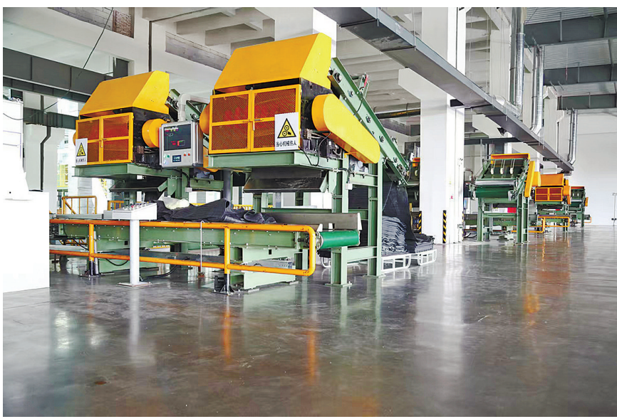
■位于平度明村镇的“共享绿色密炼中心”，实现全流程密闭生产、废气集中处理、粉尘零外溢，从源头破解橡胶行业污染难题。
