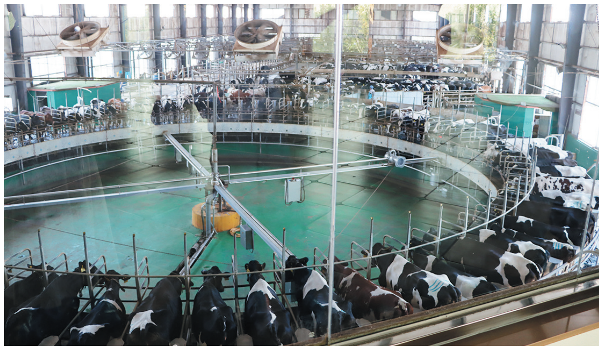
博宇牧业智慧奶厅里,80位转盘式挤奶机每小时能完成500头奶牛的挤奶任务。
