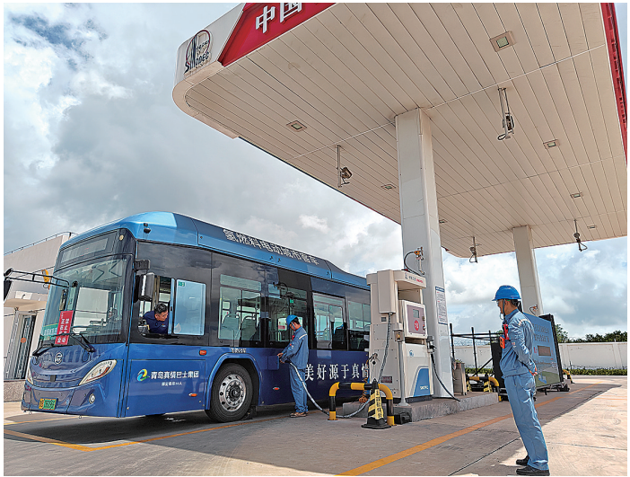
■氢燃料电池公交车在青岛炼化海河路加氢站充装氢气。 刘强 摄
