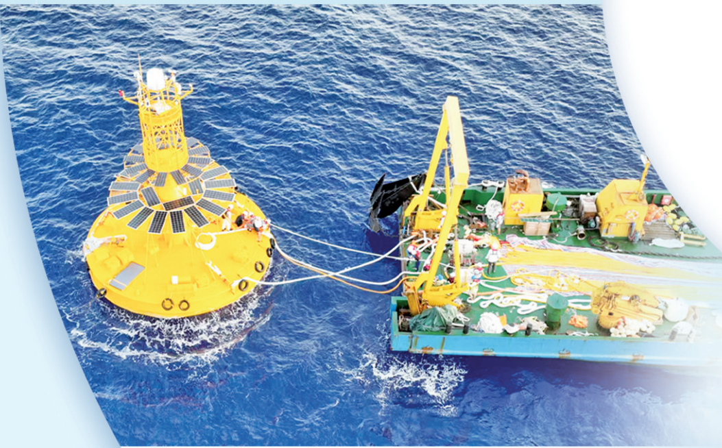
■中国科学院海洋研究所牵头研发的大剖面浮标，国内外首次在超3500米水深成功布放。
