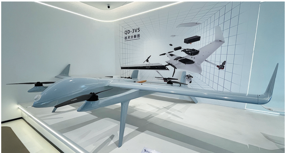
远度智能自主研发的油电混动垂直起降固定翼无人机。 周伟 摄
