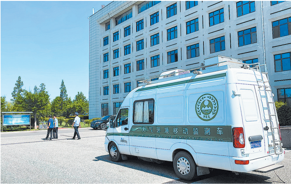
■走航监测车对企业厂区内VOCs排放量实行监测，并绘制“污染图”。
