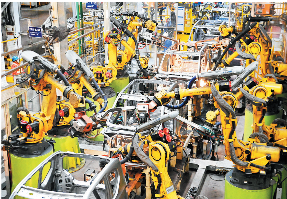
上汽通用五菱青岛基地机器人正在进行车身焊接。
