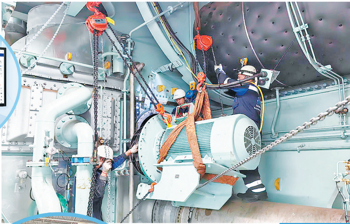
▲应船东要求,儒海船舶工程师将主机鼓风机解体送往车间检测。
