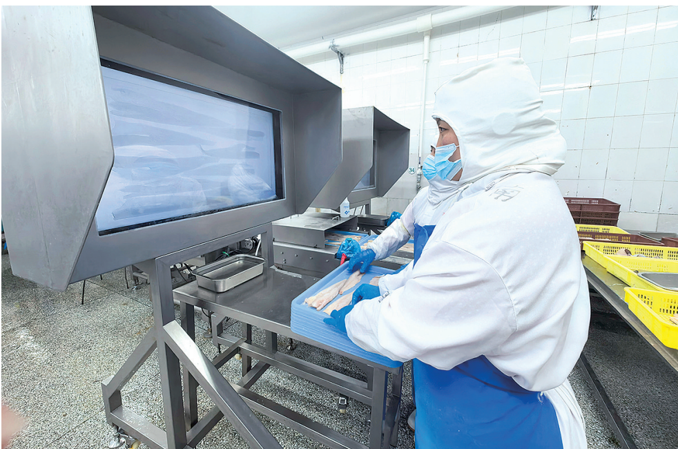
青岛福生食品有限公司工作人员用X光机检测鳕鱼刺残留情况。王萌 摄
