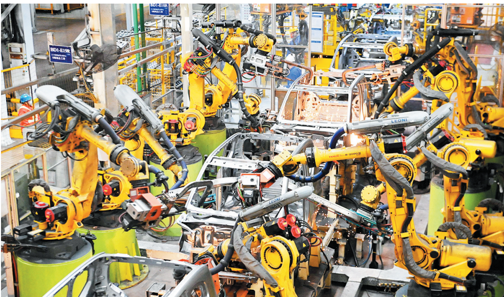
上汽通用五菱青岛分公司车间正在焊接车身。
