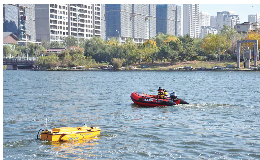
无人船等高新技术设备在海洋测绘中发挥重要作用。单位供图
