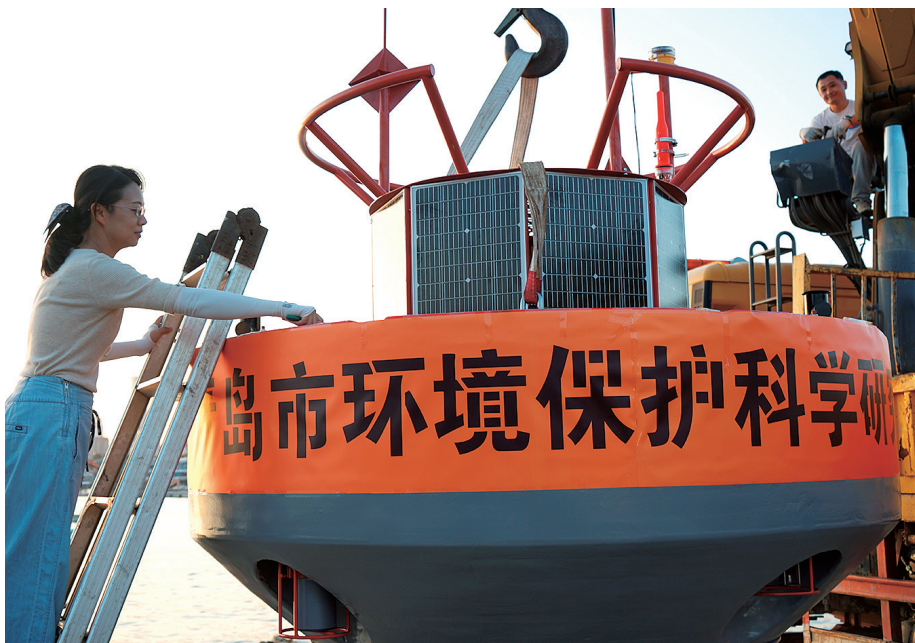
■海洋浮标自动监测系统投放准备。
