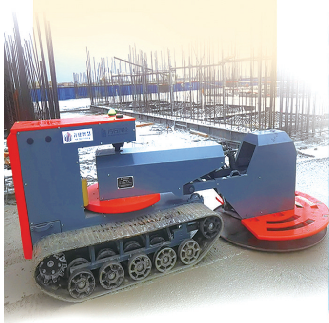
■图为正在工作中的抹平机器人。王冰洁 摄
