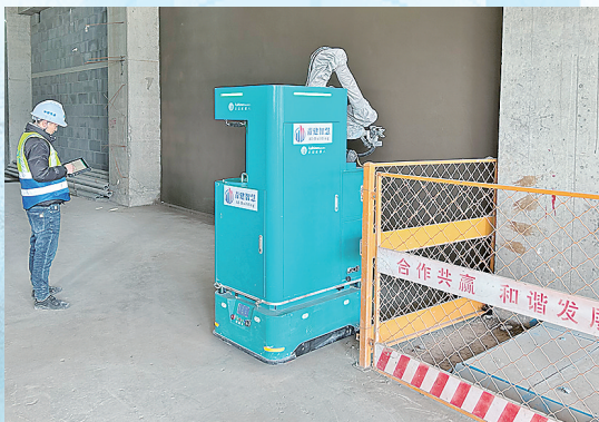
■图为喷涂机器人正在工作。王冰洁 摄
