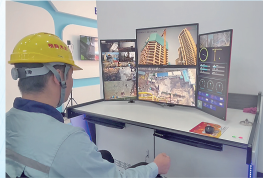
■塔吊司机坐在后台驾驶舱内远程操控无人塔吊。
