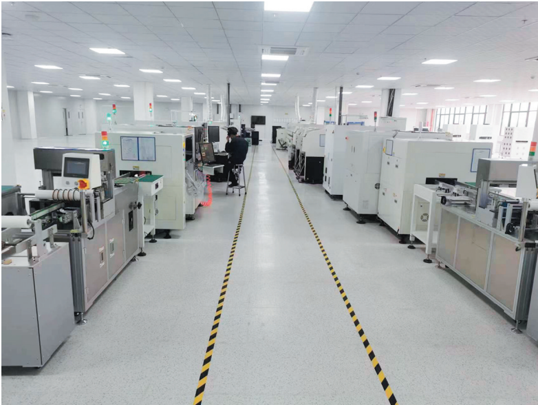
■万达光电(青岛)智造生产基地SMT贴片生产线。
