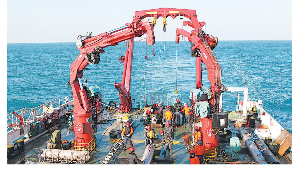
立式收放、在线通讯控制、可视化、搭载多类水下传感器的作业模式，取样系统工作稳定，5次作业全部顺利回收，单次取样长度最长达7.89米，并取到了末次盛冰期以来低海平面时期的陆相地层样品。
