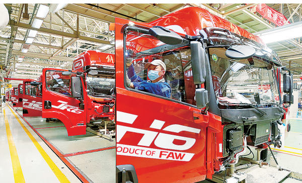
■在一汽解放总装车间,工人在安装汽车内饰。
