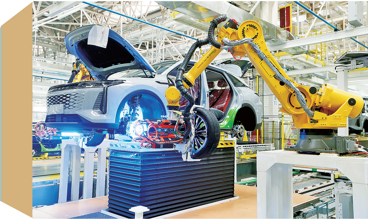
■在奇瑞青岛超级工厂总装车间,智能机器人在安装汽车轮胎。
