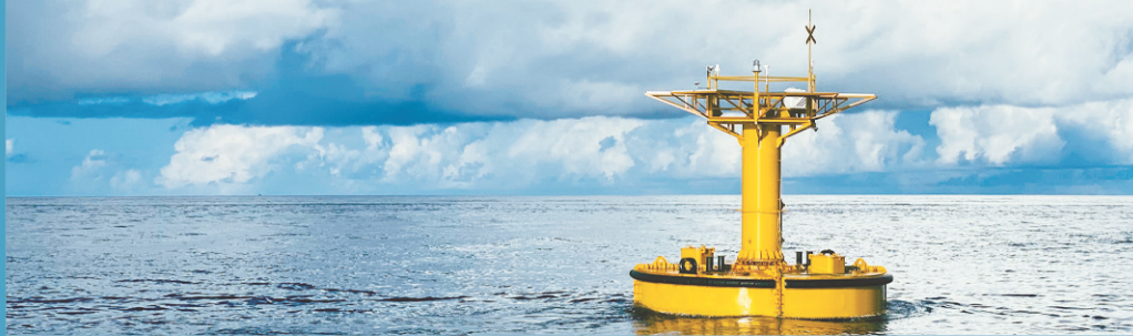
■镭测创芯研发的漂浮式测风激光雷达系统，可为海上风资源勘测、海气边界层动力学研究及海洋数值天气预报提供宝贵的剖面观测数据。
