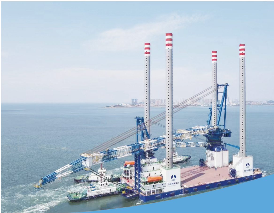
►“青岛造”1200吨自升式风电安装平台。
