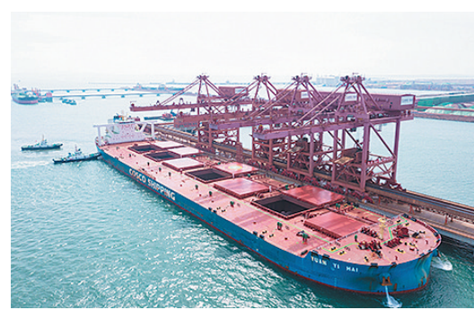
在董家口港区40万吨矿石码头,“远谊海”轮进行铁矿石国际中转作业。
