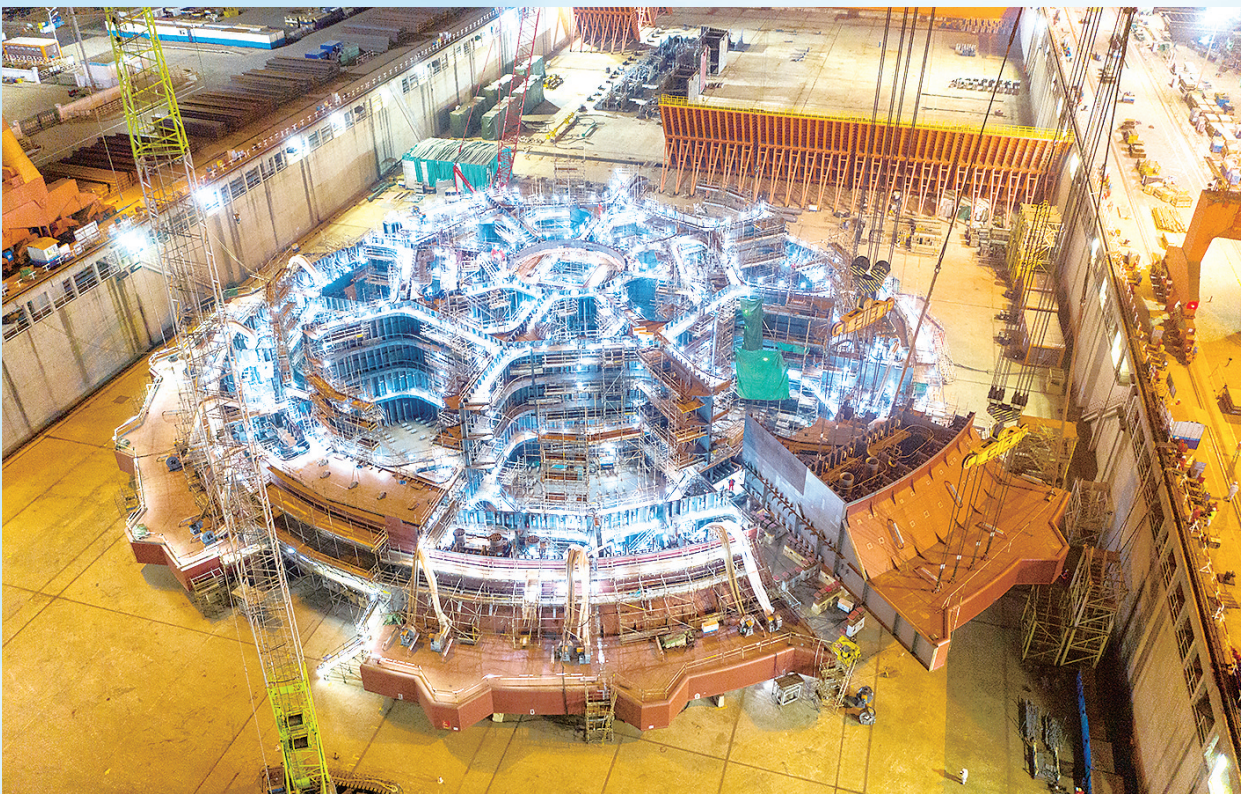
■亚洲首艘圆筒型浮式生产储卸油装置(FPSO)船体“双层底”在青合龙。
