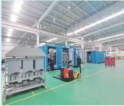
▲首套量产型分布式甲醇制氢—加氢一体站（200kg/日）在工厂下线并完成装机启动运行。
