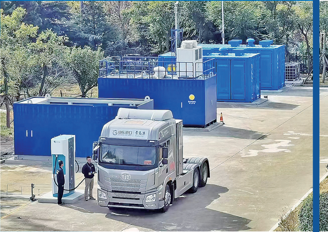
▲首套量产型分布式甲醇制氢—加氢一体站（200kg/日）在工厂下线并完成装机启动运行。
