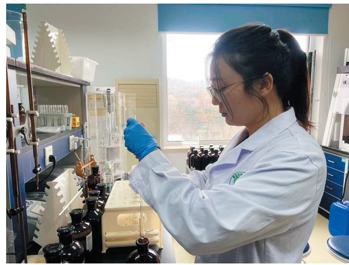
工作人员对土壤样品有机质进行测定。
