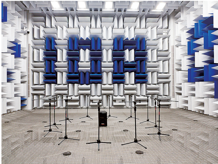
■中科院声学所北海研究站的全消声实验室六面都安装有消声尖劈，通过这种特殊消声装置，可以最大程度地降低实验室内的噪音。
