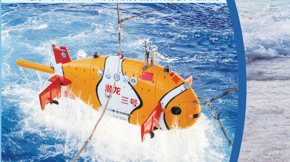
▲这是“发现”号ROV,从科考船甲板上可以看到需要加装的浮球。 ▼“潜龙三号”外形为立扁鱼形,更有利于在复杂海底地形矿区作业。
