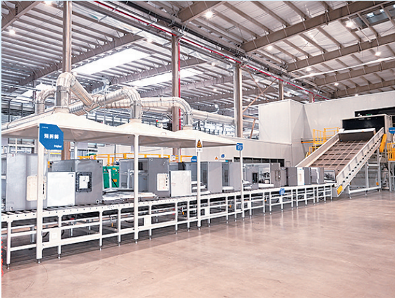
■海尔智家再循环互联工厂冰箱拆解线。
