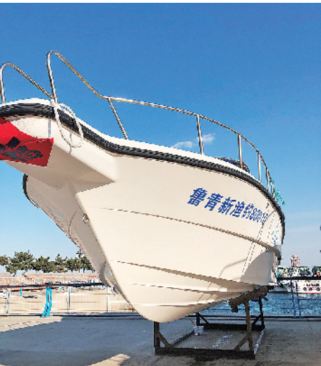
船体涂完“超滑防污涂层”在海中运行18个月後依然光滑。
