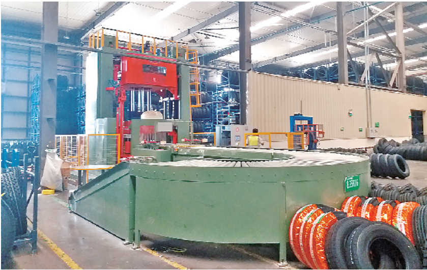
■科力达生产的智能型轮胎内胎垫带装填机。
