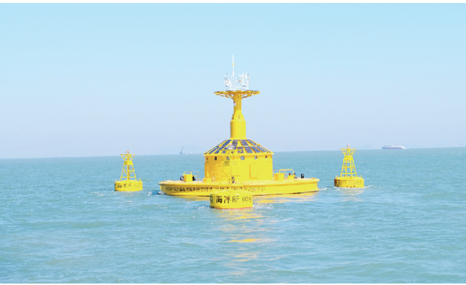
■海洋所研制的我国首套三锚式浮标综合观测平台。
