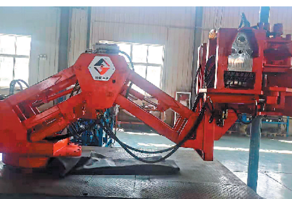
图为深海钻井机器人模拟更换钻杆。
